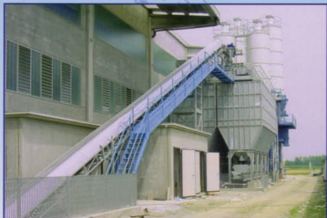
Caricamento con tramoggia primaria e nastro convogliatore con copertura antipolvere zincata.
