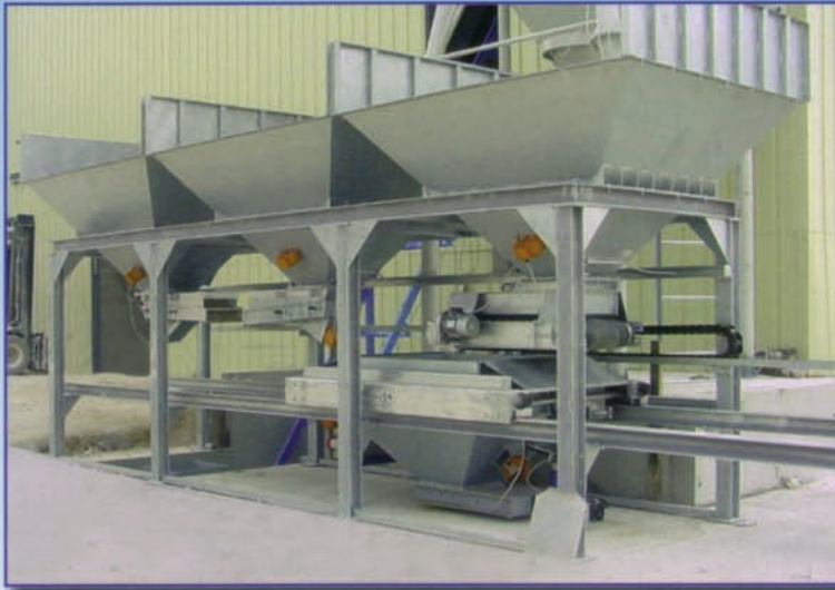
Cassetto estraattore vibrante per graniglie.
