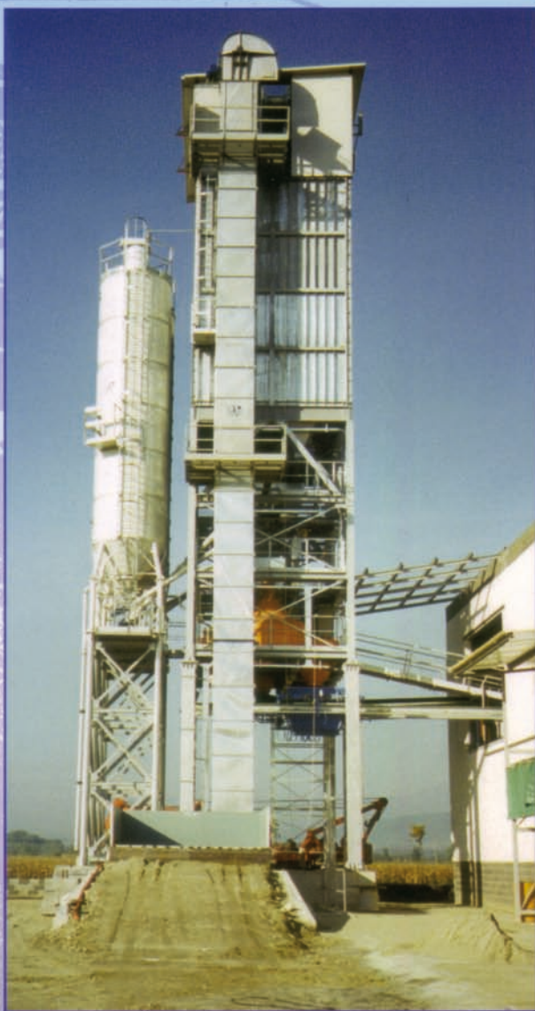
Caricamento tramoggia primaria, elevatore a tazze verticale e distribuzione nelle diverse tramogge di stoccaggio con nastro..
