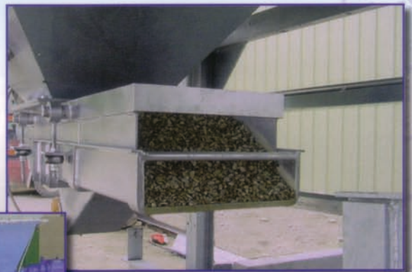
Cassetto estraattore vibrante per graniglie.
